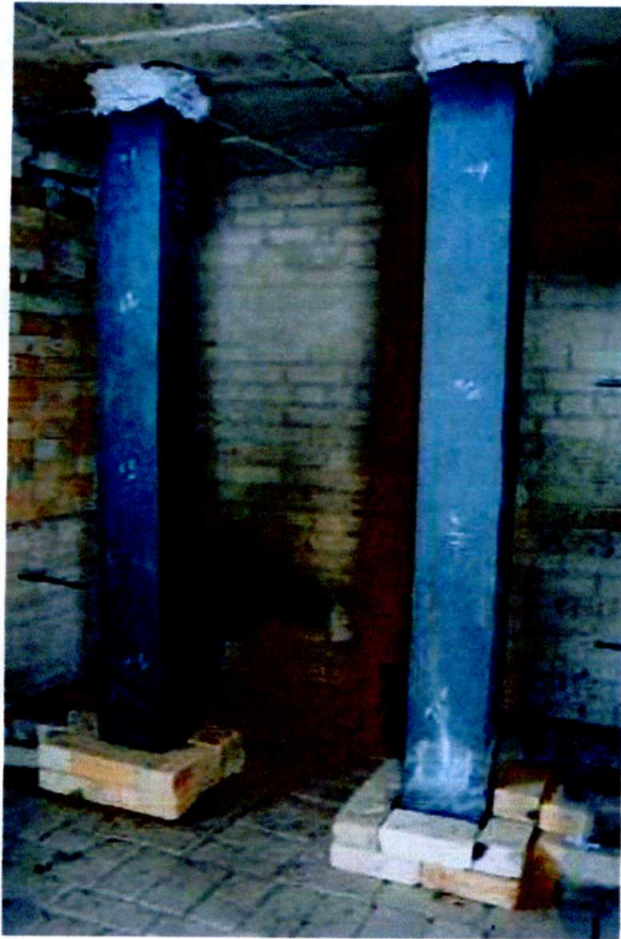
Рисунок 1. Внешний вид образцов до начала огневых испытаний: справа – образец №1, слева – образец №2.
