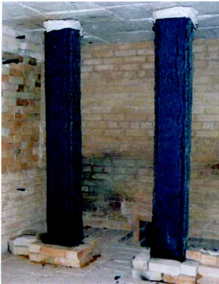
Рисунок 4. Внешний вид образцов после проведения испытаний: справа – образец №1, слева – образец №2.
