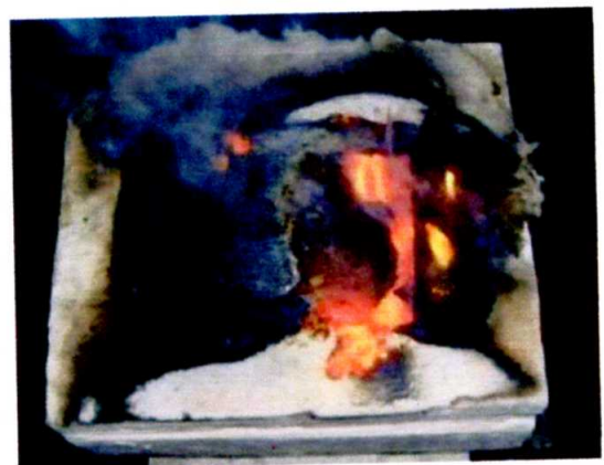
Рис.5. Внешний вид после испытаний образца металлической пластины окрашенной ОЗС «Эндотерм ХТ-150» и установленной Плитой «Эндотерм 2101014» а-вид Плиты «Эндотерм 210104»; б-вид огнезащитного покрытия «Эндотерм ХТ-150» под плитой «Эндотерм 210104».
