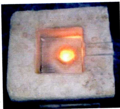
Рис.5. Внешний вид после испытаний образца металлической пластины окрашенной ОЗС «Эндотерм ХТ-150» и установленной Плитой «Эндотерм 2101014» а-вид Плиты «Эндотерм 210104»; б-вид огнезащитного покрытия «Эндотерм ХТ-150» под плитой «Эндотерм 210104».
