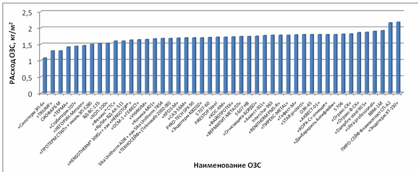
Рис. 5. Расход огнезащитного состава для получения покрытия толщиной 1 мм (R45).
