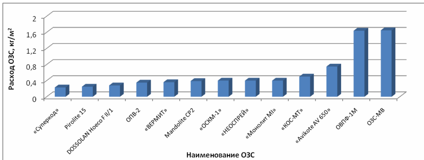
Рис. 11. Расход огнезащитного состава для получения покрытия толщиной 1 мм (R150).
